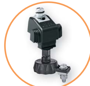
→ Затискач, тип "S" з проколом ізоляції з одного боку, обладнаний болтом із зривною голівкою і можливістю встановлення під напругою, 10 - 150 mm 2
