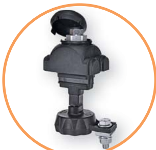
→ Затискач, тип "FK" з проколом ізоляції з двох боків, оснащений болтом зі зривною голівкою і можливістю встановлення під напругою, 10 - 95 mm 2
