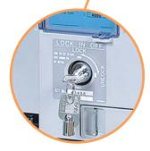
→ Блокировка "ON-OFF" возможна двух типов: замок типа "ON", блокирующий во включенном состоянии и замок тип "OFF" блокирующий в выключенном состоянии. При наличии такого замка невозможно управлять выключателем, пока не будет выбрано соответствующее положение ключа.
