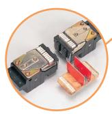
→ Силовые контакты имеют возможность замены (время замены одного полюса занимет около 15мин). Все элементы силовой контактной группы выполнены без винтовых соединений, что повышает надежность операций включения/ отключения автоматического выключателя
